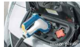
停電時、電気自動車のバッテリーを電力供給源として、利用することも可能にする 電気自動車用充電スタンド
