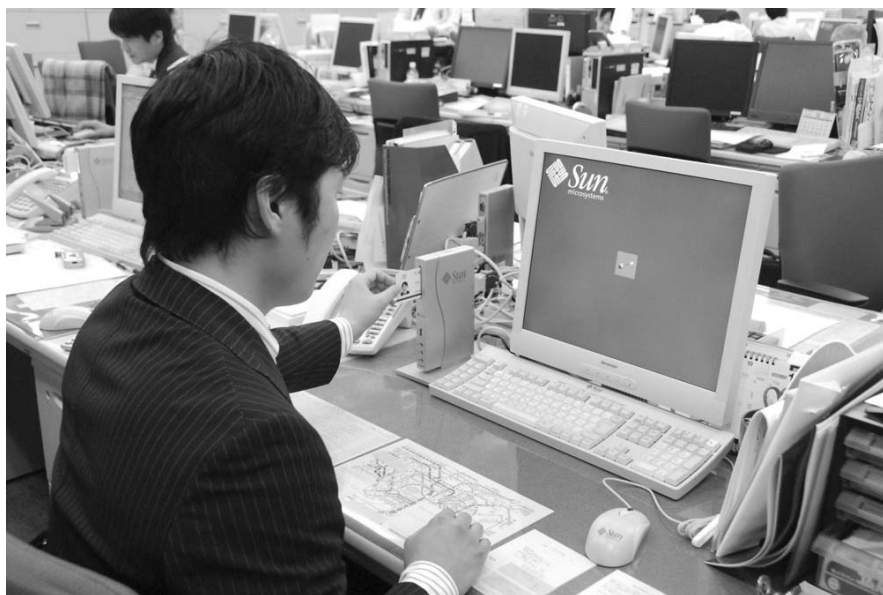
◀▲「Sun Ray 2」の本体に社員証を兼ねたICカードを挿し込む様子（左）。すぐにWindowsのログイン画面が表示される（上）。液晶ディスプレイは汎用品を使用
